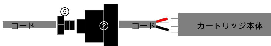
4 カートリッジを外管にいれ、②キャップを締める、⑤六角ネジをコードを少し引きながら締める。
